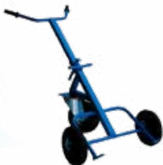
Il carrello a tre ruote per la movimentazione di fusti in ferro da 210 litri presenta un'impugnatura ergonomica a doppia presa, due ruote semipiene e una ruota girevole semipiena con diametro 260 mm, oltre all'aggancio ferma-fusto scorrevole.
