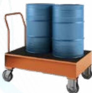
Le vasche di raccolta o contenimento carrellate sono studiate per agevolare gli spostamenti dei contenitori su essi posizionati grazie alle ruote sottostanti con diametro 200 mm. Sono realizzate in acciaio verniciato con grigliato d'appoggio superiore con maglie ad alta portata in acciaio zincato a caldo.
