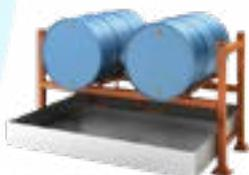
La vasca in acciaio zincato, da posizionare sugli appositi angolari posti sotto il tubolare portafusti, permette di evitare sversamenti durante le operazioni di trasferimento di liquidi.
