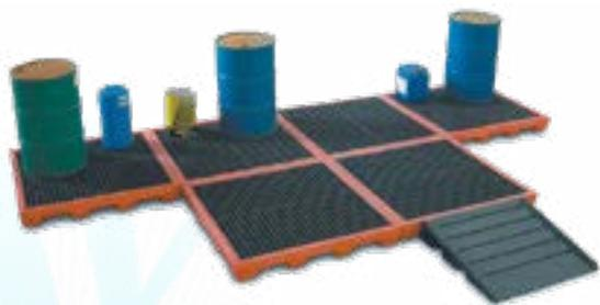
Le piattaforme con vasca in polietilene sono utili per lo stoccaggio in sicurezza dei fusti per evitare sversamenti di liquidi inquinanti. Sono modulari e ciò permette di formare ampie pavimentazioni da lavoro, robuste e resistenti ad oli e acidi. Dispongono di rampe che ne facilitano l'utilizzo.
